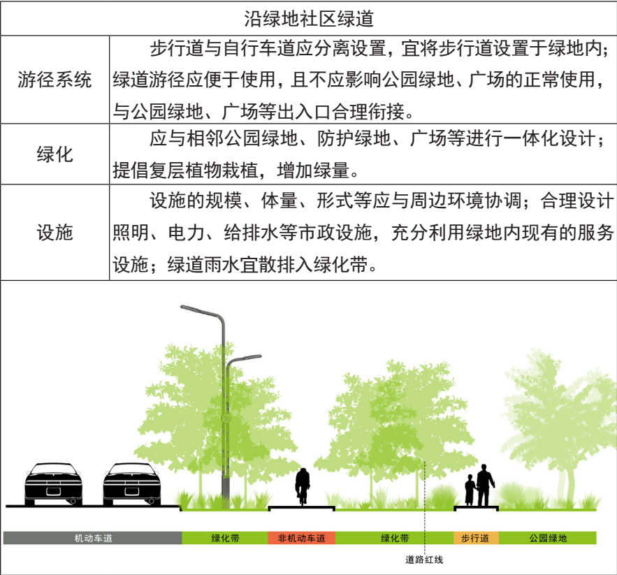
图 5.20 沿绿地社区绿道设计要求与剖面示意
